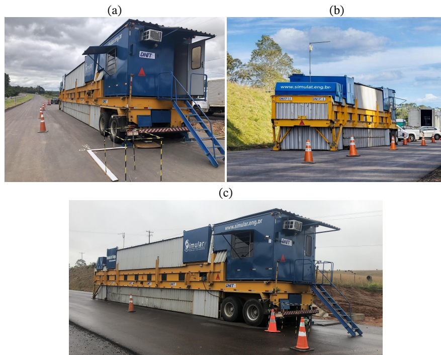
Figura 3 • Simulador de tráfego HVS nos Segmentos (a) Segmento A, (b) Segmento B e (c) Segmento C.
